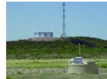
Au premier plan, l'un des 1600 détecteurs de surface des particules produites par l'interaction des rayons cosmiques avec l'atmosphère terrestre. À l'arrière-plan, l'un des quatre télescopes à fluorescence.
